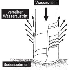
Bei der Einlaufberuhigung (EB 03 00) handelt es sich um eine echte Wasserbremse, die gleichzeitig durch die Konstruktionsform einen nach oben und breitflächig verteilten, ruhigen Wassereintritt in die Zisterne erreicht. Das Bodensediment bleibt dadurch völlig unberührt.
